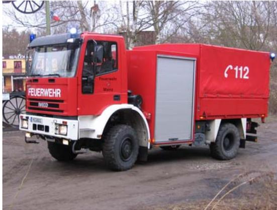
Beim SW 2000-Tr handelt es sich um ein Sonderfahrzeug aus dem Bestand des erweiterten Katastrophenschutzes. Das Fahrzeug dient zur Wasserversorgung über längere Wegstrecken und führt zu diesem Zweck 2000 Meter B-Schläuche mit, die während der Fahrt verlegt werden können. Außerdem ist eine transportable Pumpe, eine sogenannte Tragkraftspritze auf dem Fahrzeug verladen, weshalb es bei Bedarf auch über die Ortsgrenzen hinaus eingesetzt werden kann.
